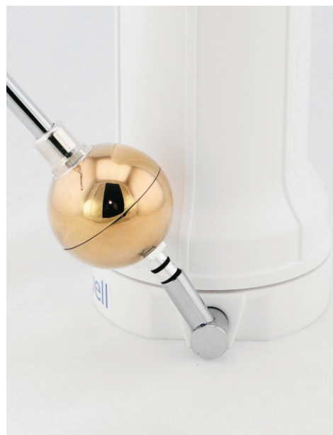
Abb. 2 Drehen Sie die Auslaufpfeife des Filters um 45° nach links. Stecken Sie die UMH-Kugel mit den beiden Gummidichtungen durch leichtes Drehen (evtl. mit Wasser anfeuchten) in die Aufnahmever schraubung.
